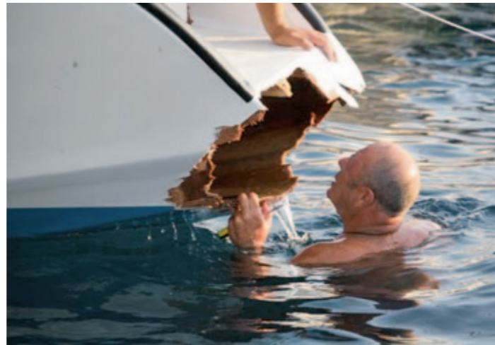
▲ Heck weg: Starker Schwell einer Fähre hat die Mooringleine brechen lassen und den Kat an die Pier geschlagen
