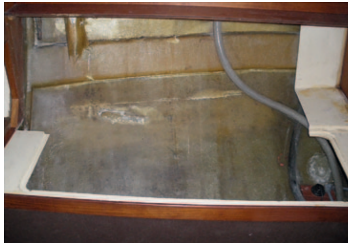
▲ Im Inneren der Yacht ist der Kratzer der Containerecke deutlich zu erkennen. Der Wassereinbruch war beträchtlich
